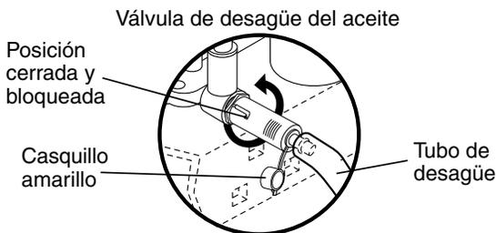
3. Abra la válvula de desagüe empujando hacia dentro y dando vuelta a la izquierda.
