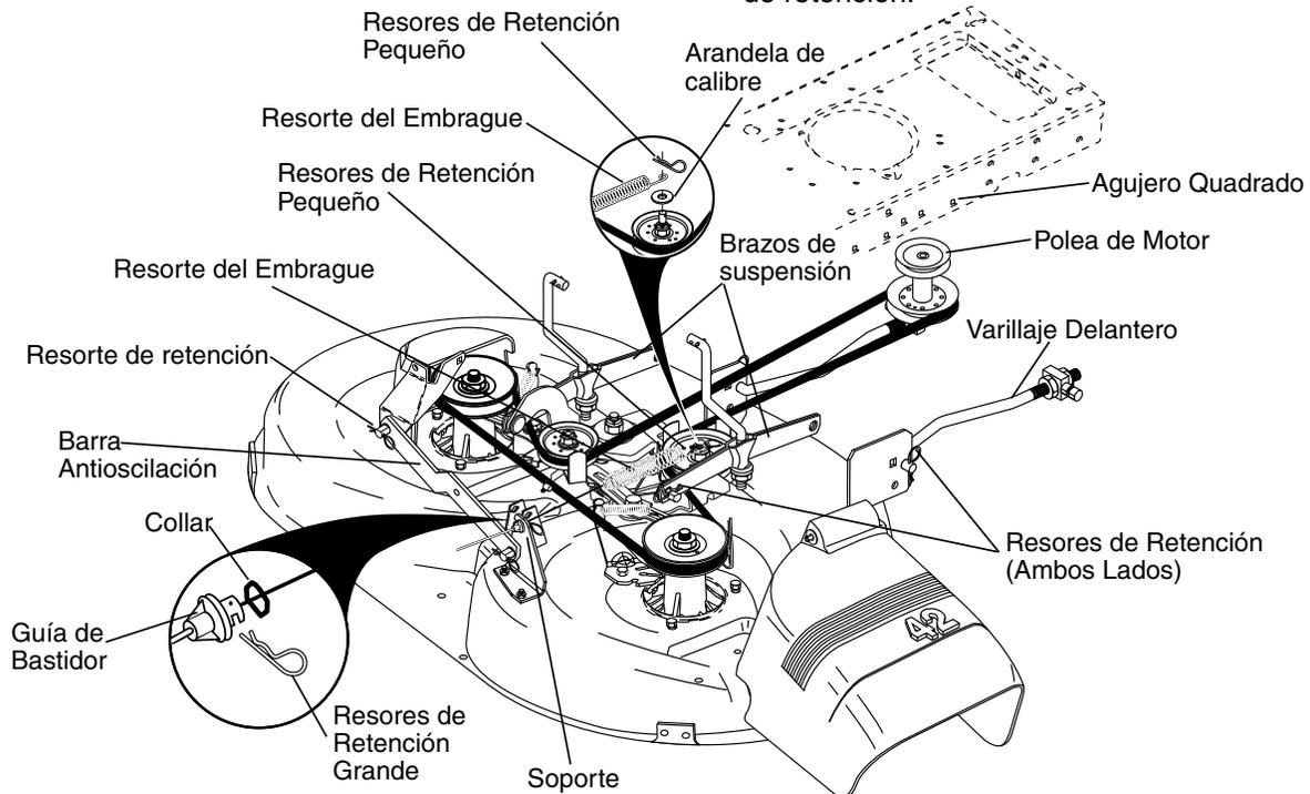
7. Empuje la guía de la cubierta del cable del embrague en el soporte, deslice el collar sobre la guía y asegúrela con el resorte grande de retención.
