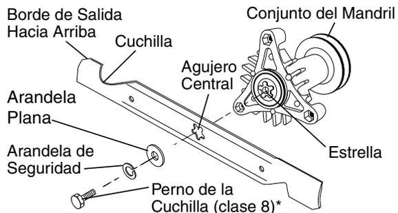
\*Se puede identificar a un perno de clase 8 tratado a calor por las seis líneas en la cabeza del perno.
