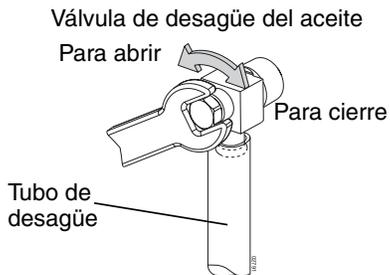
4. Después de drenar completamente el aceite, cerrar la válvula de drenaje girando en el sentido de las agujas del reloj. Usar la llave inglesa de 7/16" (11mm) para aplicar una pequeña torsión para mantenerla cerrada. No apretar más de lo necesario.
