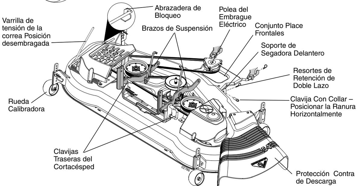
9. COLOCAR LAS CLAVIJAS TRASERAS- Unir el lado derecho primero. Sacra y tener la clavija del resorte cargado, alinear el agujero en el brazo de suspensión y soltar la clavija. Asegurarse de que la clavija vuelva a la posición completamente sentada y que esté unida al brazo de suspensión.
