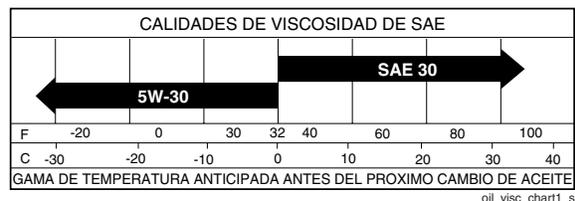
**AVISO:** A pesar de que los aceites de multiviscosidad (5W30, 10W30, etc.) mejoran el arranque en clima frío, estos aceites de multiviscosidad van a aumentar el consumo de aceite cuando se usan en temperaturas sobre 32° F (0° C). Revise el nivel del aceite del motor más a menudo, para evitar un posible daño en el motor, debido a que no tiene suficiente aceite.
