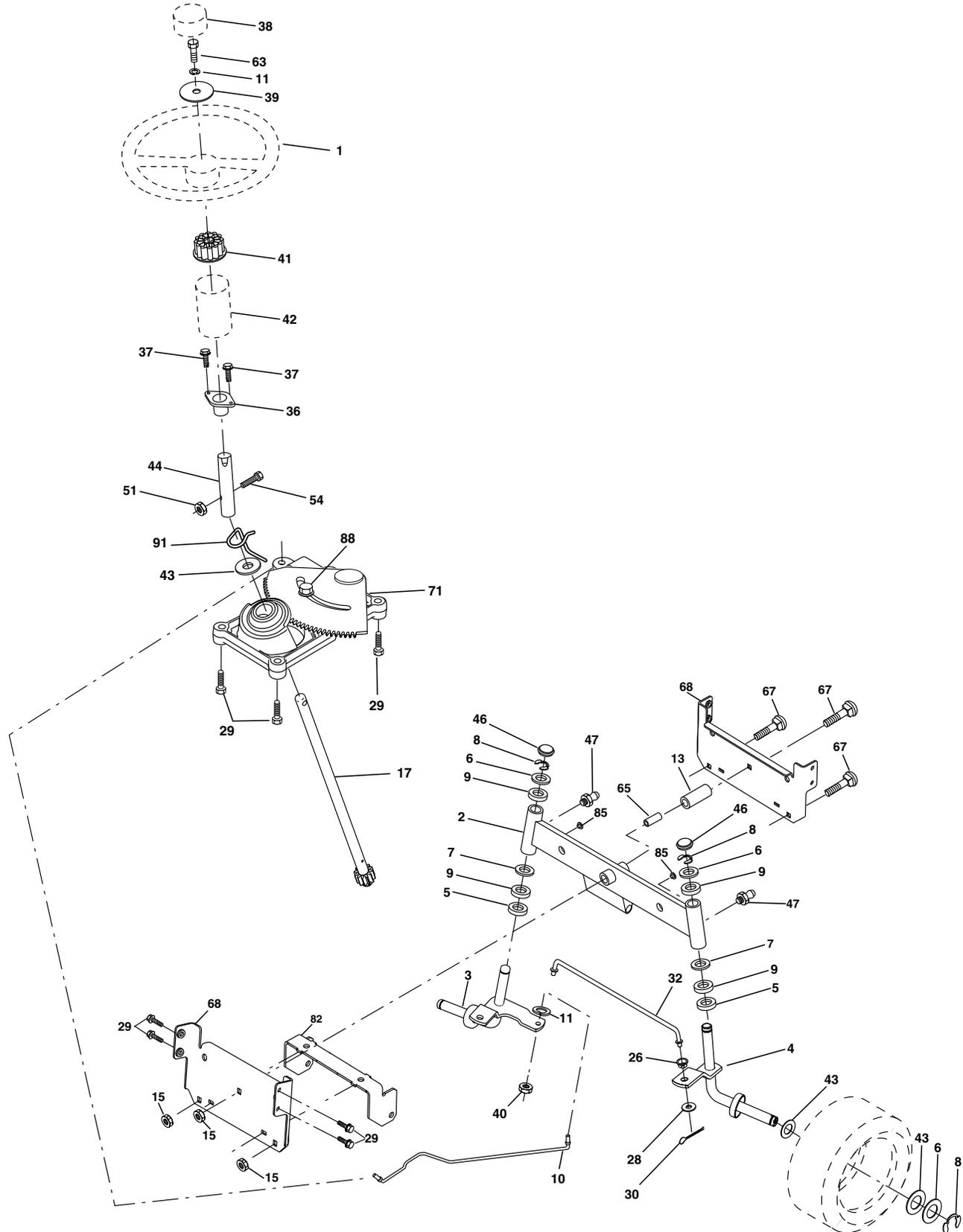
**PIÈCES DE RECHANGE****TRACTEUR - - NUMÉRO DE MODÈLE PO14542D****ENSEMBLE DE LA DIRECTION**
