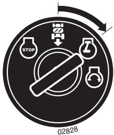
POSITION DE MOTEUR ON
