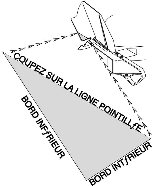
UTILISEZ LE TRIANGLE CI-DESSUS COMME UN GUIDE POUR CISAILLER À LARGEUR VOTRE DÉFLECTEUR DE DÉCHARGE. DÉCOUPEZ LA PARTIE OMBRÉE ET METTEZ-LA SUR LE BORD DE FOND À L'INTÉRIEUR DU DÉFLECTEUR. CISAILLEZ LE DÉFLECTEUR SUR LA LIGNE POINTILLÉE EN UTILISANT LES GROSSES CISAILLES OU UN SCIE À MAIN.
