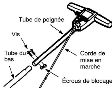
**NOTE:** Quand vous faites l'opération suivante, assurez-vous que le corde de mise en marche ne soit pas coincée par le pinces de câble. La corde de mise en marche doit pendre librement pour bien fonctionner.
