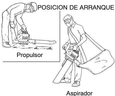
**ADVERTENCIA:** Al arrancar el motor, sostenga el aparato como se ilustra en la figura. Apoye el aparato exclusivamente en una superficie limpia y sólida siempre que vaya a efectuar el arranque y siempre que tenga que apoyar el aparato con el motor en marcha. Los escombros tales como gravilla, arena, tierra, césped, etc., pueden ser succionados por la entrada de aire y arrojados por la salida de propulsión, dañando el aparato u otros bienes o causando graves heridas a espectadores o al usuario.
