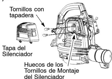
**AVISO:** Los tornillos de montaje del silenciador están situados detrás de los tornillos con tapadera. Los tornillos con tapadera se deben quitar para tener acceso a los tornillos de montaje.
