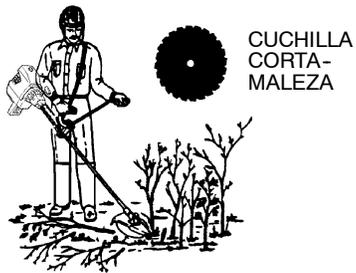
**AVISO:** Si su aparato ha sido armado para el uso de cabezal de corte, refiérase a la sección **INSTALACION DE LA PROTECTOR PLASTICA Y EL CABEZAL DE CORTE** y siga los pasos opuestos para remover la protector plástica y el cabezal de corte antes de montar la protector metálica y la cuchilla. Almacene estas piezas para uso futuro. Nunca use el cabezal de corte con la cuchilla metálica instalada.
