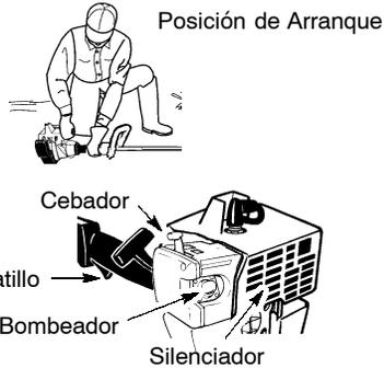
**⚠ ADVERTENCIA:** El cabezal de corte girará mientras se esté intentando poner en marcha el motor. Evite el hacer ningún tipo de contacto con el silenciador. Un silenciador caliente podría provocar quemaduras de gravedad si se toca.
