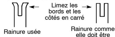
Remplacez la barre-guide quand la glissière est usée, quand la barre-guide est tordue ou craquelée ou quand un trop grand échauffement ou ébarbage des glissières se produit. Si vous devez remplacer la barre-guide, n'utilisez que celle qui est spécifiée pour votre tronçonneuse dans la liste de pièces ou sur le décalque de la tronçonneuse.
