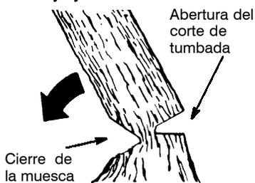
**AVISO:** Antes de completar el tumbado, use cuñas para abrir el corte, cuando sea necesario, para controlar la dirección de la caída. Use cuñas de madera o de plástico, pero nunca de acero o de hierro, para evitar que la sierra recule y para evitar daños a la cadena.
