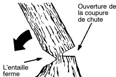
**REMARQUE:** Avant d'achever la coupure de chute, employez des cales pour ouvrir la coupure si nécessaire afin de contrôler la direction de chute. Employez des cales en plastique ou en bois, mais jamais en acier ou en fer, afin d'éviter de recul et des dégâts à la chaîne.
