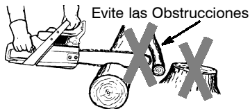
Despeje el Area de Trabajo
