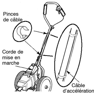
7. Alignez une pince de câble au dessus des boulons du tube et l'autre sous la poignée de la corde de mise en marche. Montez les pinces de câble une par une autour du tube et du câble d'accélération.
