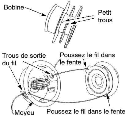
5. Embobinez le fil dans la bobine en maintenant sa tension et avec régularité. Embobinez dans la direction des flèches que vous trouverez sur la bobine.
