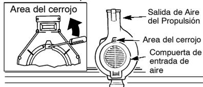
3. Suavemente, gire el mango del destornillador hacia la parte trasera del aparato, mientras, tire hacia arriba de la compuerta de la entrada de aire del aspirador con su otra mano.
