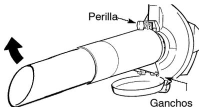
6. Al volver a convertir al aparato en propulsor de aire, asegúrese de que la parte ajustada de la compuerta de entrada de aire del aspirador se encuentre bien fija.
