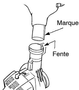
5. Introduisez le tube coudé dans la sortie de souffleur. Assurez-vous que le marque du tube coudé est aligné avec la fente de la sortie de souffleur.
