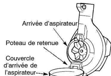
5. Mettez les crochets du tube d'aspirateur sur les poteaux de retenue et faites pivoter le tube pour le mettre en position. Attachez le tube d'aspirateur en tournant le bouton dans le sens des aiguilles d'une montre jusqu'à ce qu'il soit serrée.
