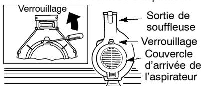
3. Soulevez doucement le bout du tournevis vers l'arrière de l'appareil en tirant sur le couvercle de l'arrivée d'aspirateur de l'autre main.
