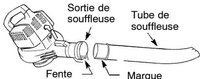
2. Serrez l'écrou du tube en tournant le bouton dans le sens des aiguilles d'une montre.
