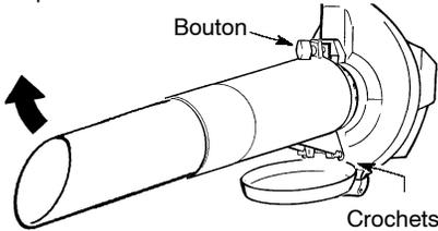
6. Quand vous convertissez l'appareil en souffleuse, assurez-vous que le couvercle de l'arrivée de l'aspirateur est bien verrouillé.
