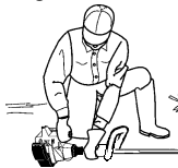
Position de Mise en Marche
