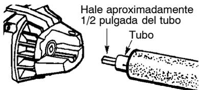
**AVISO:** La punta del mango de funcionamiento es cuadrada. Esta punta cuadrada entra dentro de un orificio cuadrado en un eje dentro del motor. Mire dentro del motor y usted verá el orificio cuadrado en el eje. Introduzca el tubo en el hueco.
