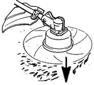
Siempre toque el cabezal contra el suelo en un área con césped. Si se hace tacar contra las superficies como son el cemento o el asfalto, puede ocasionar desgastes excesivos al bacezal como resultado.
