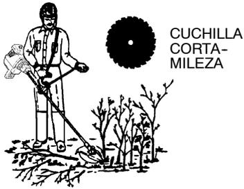
**AVISO:** Si su aparato ha sido armado para el uso de cabezal de corte, refiérase a la sección **INSTALACION DE LA CUBIERTA DE PLASTICO Y DEL CABEZAL DE CORTE** y siga los pasos opuestos para remover la cubierta plástica y el cabezal de corte antes de montar la cubierta de metal y la cuchilla. Almacene estas piezas para uso futuro. Nunca use el cabezal de corte con la cuchilla de metal instalada.
