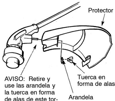
AVISO: Retire y use las arandela y la tuerca en forma de alas de este tornillo para montar el protector.
