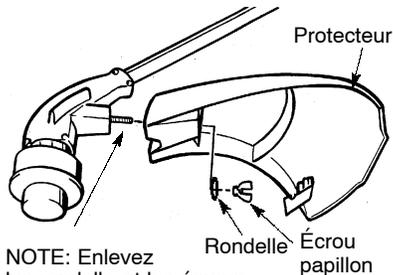
NOTE: Enlevez les rondelle et les écrous papillons de ce boulon et utilisez-les pour monter le protecteur.
