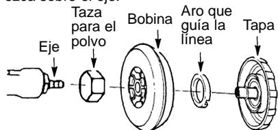
Utilice una bobina previamente enrollada o vuelva a enroscar línea nueva en la bobina existente. Si utiliza una bobina pre-enrollada, retire la tira adhesiva de la línea y la bobina.
