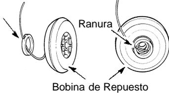
3. Coloque el aro guía en la bobina y pase la línea por la ranura. Permita que la línea se extienda de 10 a 15 cm (4 a 6 pulgadas) desde el centro de la bobina.
