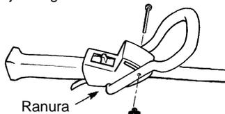
**AVISO:** La perilla de ajuste deberá ser instalada en el lado izquierdo de el aparato como se muestra en el ilustración.
