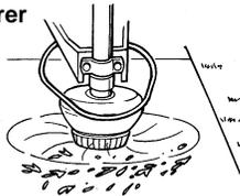
**PARA BORDEAR** - Ajuste el aparato a la posición del bordeado (vea la sección TWIST AND EDGE). Mientras se encuentre bordeando, permita que sea la punta de la línea la que haga el contacto con el material a bordear. No fuerce la línea.
