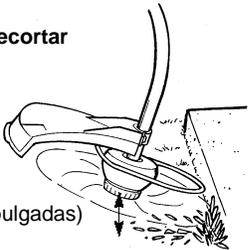
**PARA ESCALPAR** - La técnica del ascalpado retira la vegetación no deseada abajo a la tierra. Sostenga el cabezal unos 8 cm (3 pulgadas) del suelo y en ángulo. Deje que la punta de la línea golpee contra el suelo cerca de los árboles, los postes, los monumentos, etc. Esta técnica incrementa el desgaste de la línea.
