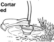
**PARA BARRER** - Se puede usar la acción ventiladora de la línea girante para barrer rápida y fácilmente un área determinada. Mantenga la línea paralela al suelo directamente encima de las superficies que se quiera barrer y mueva el aparato de un lado al otro rápidamente.
