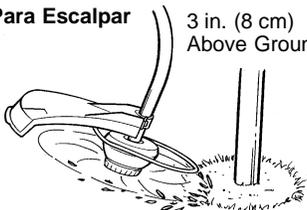
**PARA CORTAR CESPED** - Este aparato es ideal para cortar césped en lugares donde las cortadoras convencionales no llegan. En posición de cortar césped, mantenga la línea paralela al suelo. Evite presionar el cabezal con-
