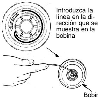
2. Introduzca un extremo de la línea dentro de la cavidad central de la bobina vacía. Asegúrese de que la línea enrolle en la bobina en la dirección que se ilustra en la misma (en sentido contrario al de las agujas del reloj).
