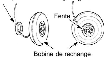
3. Posez l'anneau de guidage sur la bobine et placez le fil dans la fente. Permettez au fil de sortir de 10 à 15 cm (4 - 6 pouces) à partir du centre de la bobine.
