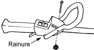
**REMARQUE:** La bouton de réglage doit être fixé sur le côté de l'appareil opposé à celui où se tient l'utilisateur.
