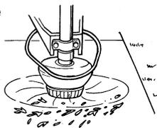
**COUPE DE BORDURE** - Ajustez le coupe-herbe sur la position d'bordure (voir la section TWIST AND EDGE). Permettez seulement le bout du fil entrer en contact. Ne forcez pas la fil dans la zone de travail.
