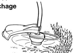
**BALAYAGE** - Vous pouvez utiliser l'action de balayage du fil de coupe pour nettoyer vite et facilement. Maintenez le fil parallèle aux surfaces balayées et au dessus d'elles et bougez l'appareil d'un côté à l'autre.
