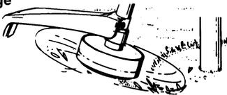
le fil parallèle au sol. Évitez de presser la tête dans le sol car cela peut raser le sol et endommager l'appareil.
