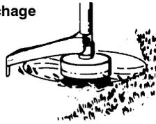
**BALAYAGE** - Vous pouvez utiliser l'action de balayage du fil de coupe pour nettoyer vite et facilement. Maintenez le fil parallèle aux surfaces balayées et au dessus d'elles et bougez l'appareil d'un côté à l'autre.
