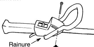
**REMARQUE:** La bouton de réglage doit être fixé sur le côté de l'appareil opposé à celui où se tient l'utilisateur.
