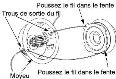
5. Embobinez le fil dans la bobine en maintenant sa tension et avec régularité. Embobinez dans la direction des flèches que vous trouverez sur la bobine.
