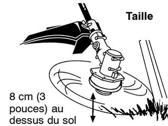
**RASAGE** - La technique de rasage retire toute végétation non désirée. Maintenez le bas de la tête de coupe à environ 8 cm (3 pouces) du sol et à un angle. Permettez à la pointe du fil de frapper le sol autour des arbres, des piquets, des monuments, etc. Avec cette technique, le fil s'use plus vite.
