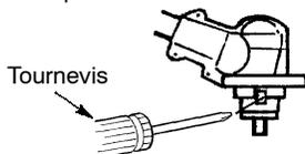
7. En maintenant le tournevis en position, montez la tête de coupe sur l'arbre dans la direction indiquée sur la décalcomanie. Serrez bien.
