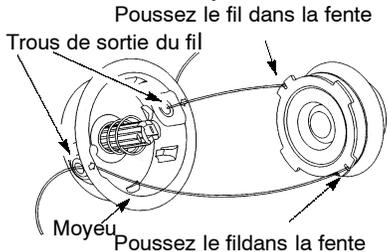
5. Embobinez le fil dans la bobine en maintenant sa tension et avec régularité. Embobinez dans la direction des flèches que vous trouverez sur la bobine.
