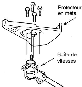
2. Insérez les quatre vis de montage par le dessous de la protecteur. Vissez-les dans la boîte de vitesses. Serrez les vis uniformément pour qu'elles tiennent avec une des clés fournies.
