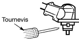
9. Serrez fermement l'écrou avec une clef en maintenant le tournevis en position. S'enlève le tournevis.
