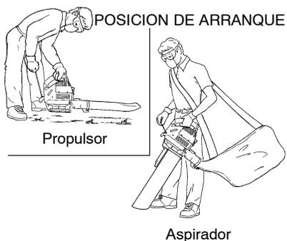
**ADVERTENCIA:** Al arrancar el motor, sostenga el aparato como se ilustra en la figura. Apoye el aparato exclusivamente en una superficie limpia y sólida siempre que vaya a efectuar el arranque y siempre que tenga que apoyar el aparato con el motor en marcha. Los escombros tales como gravilla, arena, tierra, césped, etc., pueden ser succionados por la entrada de aire y arrojados por la salida de propulsión, dañando el aparato u otros bienes o causando graves heridas a espectadores o al usuario.
