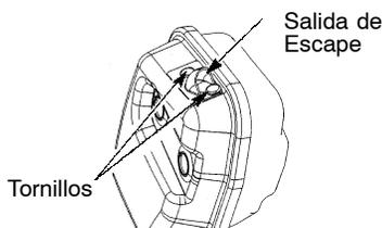
Cambie la rejilla antichispa cada 50 horas de la operación o si observa algún daño o roturas en la rejilla.
