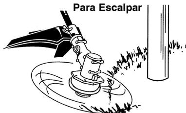
**PARA CORTAR CESPED** - Este aparato es ideal para cortar césped en lugares donde las cortadoras convencionales no llegan. En posición de cortar césped, mantenga la línea paralela al suelo. Evite presionar el cabezal contra el suelo, ya que de hacerlo podría escalpar la vegetación y dañar el aparato.
