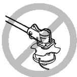
**ADVERTENCIA:** La cuchilla sigue girando incluso después de soltar el acelerador o de apagar el motor. Incluso cuando está girando libremente, la cuchilla puede despedir objetos o causar cortes profundos si se toca accidentalmente. Detenga la cuchilla poniendo en contacto el lado derecho de la misma con material ya cortado.
