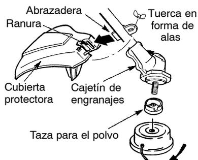
**AVISO:** Antes de instalar el cabezal de corte, asegúrese de que todos los componentes estén instalados correctamente según aparecen en la ilustración.
