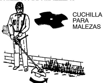
**AVISO:** Remueva el cabezal de corte y el protector plástica antes de instalar el protector metálica y instalar la cuchilla para malezas. Para remover el cabezal de corte, empuje hacia adentro la palanca de cierre y sostenga. Gire el cabezal de corte hasta que la palanca de cierre caiga dentro de una de las ranuras en la taza para el polvo. Continúe sosteniendo hacia dentro la palanca de cierre. Esto impedirá que el eje gire mientras afloja el
