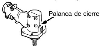
9. Continúe sosteniendo hacia dentro la palanca de cierre. Esto impedirá que el eje gire mientras ajusta la tuerca de la cuchilla.
