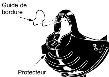
1. Tenez le protecteur à un angle avec le boîtier du moteur. Alignez le tabulateur de verrouillage sur le devant du protecteur avec la fente avant du boîtier du moteur (voir l'illustration ci-dessous).
