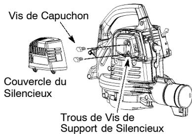
**REMARQUE:** Les vis de support de silencieux sont derrière les vis de capuchon. Les vis de capuchon doivent être enlevées pour avoir accès aux vis de support.
