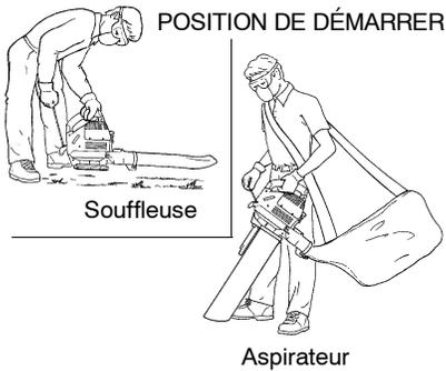
**AVERTISSEMENT:** Lors du démarrage, tenez l'appareil tel qu'indiqué. Lors du démarrage du moteur ou durant son fonctionnement, ne déposez l'appareil que sur une surface propre et solide. Des débris tels que gravier, sable, poussière, herbe, etc. pourraient s'introduire dans l'arrivée d'air, être projetés par la décharge et endommager l'appareil ou les biens ou causer de blessures graves à l'utilisateur ou à des tiers.
