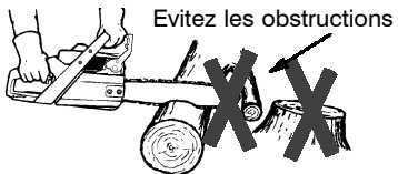
Dégager l'endroit du travail
