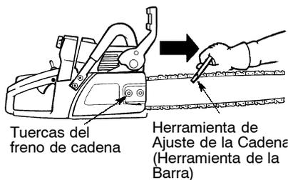
Se ajusta la tensión de la cadena aflojando las tuercas de la freno de cadena y girando el tornillo de ajuste 1/4 de vuelta mientras se mantiene la barra levantada.
