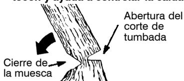
**AVISO:** Antes de completar el tumbado, use cuñas para abrir el corte, cuando sea necesario, para controlar la dirección de la caída. Use cuñas de madera o de plástico, pero nunca de acero o de hierro, para evitar que la sierra recule y para evitar daños a la cadena.
