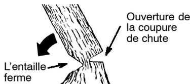
**REMARQUE:** Avant d'achever la coupure de chute, employez des cales pour ouvrir la coupure si nécessaire afin de contrôler la direction de chute. Employez des cales en plastique ou en bois, mais jamais en acier ou en fer, afin d'éviter de recul et des dégâts à la chaîne.
