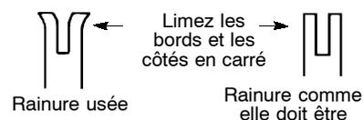
Remplacez la barre-guide quand la glissière est usée, quand la barre-guide est tordue ou craquelée ou quand un trop grand échauffement ou ébarbage des glissières se produit. Si vous devez remplacer la barre-guide, n'utilisez que celle qui est spécifiée pour votre tronçonneuse dans la liste de pièces ou sur le décalque de la tronçonneuse.
