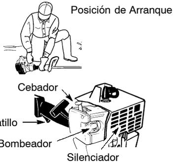
**ADVERTENCIA:** El cabezal de corte se moverá cuando comience a encender el motor de su unidad. Cuando el silenciador se encuentra caliente puede causar graves quemaduras.
