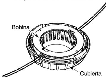
11. Asegúrese de que la línea no se meta entre el borde de la bobina y la pared de la cubierta.
