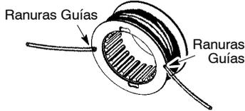
9. Introduzca la puntas de las líneas dentro de los huecos de salida en la cubierta.10. Coloque la bobina en la cubierta.
