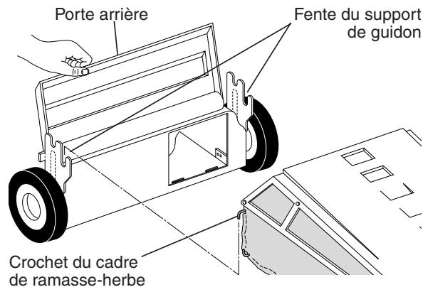
**ATTENTION:** Sous l'usage normal, le matériau de ramasse-herbe est soumis à la détérioration et à l'usure et donc, devrait être vérifié souvent pour le remplacement. Tout ramasse-herbe de recharge devrait être vérifié pour assurer conformément aux spécifications du fabricant originel.
