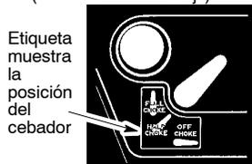
8. Tire firmemente del mango de la cuerda de arranque hasta que el motor arranque, pero no más de 6 tirones. Si el motor no arranca después del sexto tirón de la cuerda de arranque (con la palanca del cebador en la posición HALF CHOKE),
