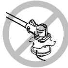
**⚠ AVERTISSEMENT:** La lame continue à tourner après avoir relâché l'accélérateur ou arrêté le moteur. La lame en rotation peut projeter des objets ou vous couper gravement si touchez. Arrêtez la lame en touchant la matière coupée avec le côté droite de la lame en rotation.
