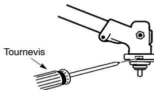
9. Serrez fermement l'écrou avec une clef en maintenant le tournevis en position.
