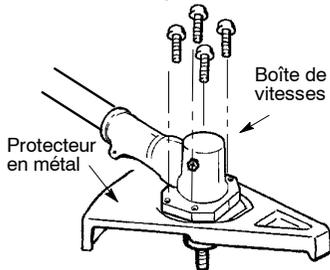
2. Insérez et vissez les 4 vis de montage à travers les trous de la boîte de vitesses et la protecteur en métal. Serrez-les à fond avec l'une des clés hexagonales fournies.
