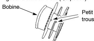
5. Embobinez le fil dans la bobine en maintenant sa tension et avec régularité. Embobinez dans la direction des flèches que vous trouverez sur la bobine.
