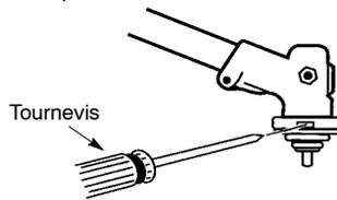
7. En maintenant le tournevis en position, montez la tête de coupe sur l'arbre dans la direction indiquée sur la décalcomanie (dans le sens inverse des aiguilles d'une montre). Serrez bien.
