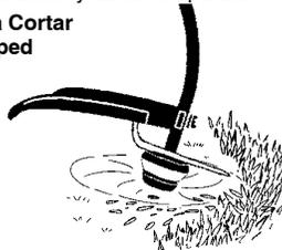
**PARA BARRER** - Se puede usar la acción ventiladora de la línea girante para barrer rápida y fácilmente un área determinada. Mantenga la línea paralela al suelo directamente encima de las superficies que se quiera barrer y mueva el aparato de un lado al otro rápidamente.
