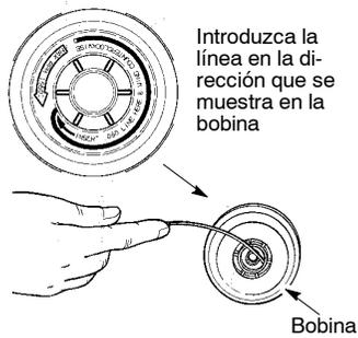
Introduzca la línea en la dirección que se muestra en la bobina
