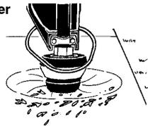
**PARA BORDEAR** - Ajuste el aparato a la posición del bordeando (vea la sección TWIST AND EDGE). Mientras se encuentre bordeando, permita que sea la punta de la línea la que haga el contacto con el material a bordear. No fuerce la línea.
