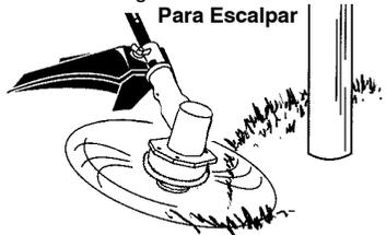
**PARA CORTAR CÉSPED** - Este aparato es ideal para cortar césped en lugares donde las cortadoras convencionales no llegan. En posición de cortar césped, mantenga la línea paralela al suelo. Evite presionar el cabezal contra el suelo, ya que de hacerlo podría escalar la vegetación y dañar el aparato.
