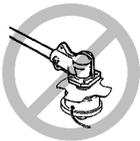
**⚠ ADVERTENCIA:** La cuchilla sigue girando incluso después de soltar el acelerador o de apagar el motor. Incluso cuando está girando libremente, la cuchilla puede despedir objetos o causar cortes profundos si se toca accidentalmente. Detenga la cuchilla poniendo en contacto el lado izquierdo de la misma con material ya cortado.
