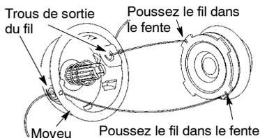
5. Embobinez le fil dans la bobine en maintenant sa tension et avec régularité. Embobinez dans la direction des flèches que vous trouverez sur la bobine.
