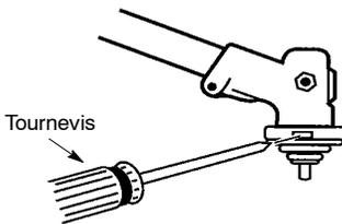
3. En maintenant le tournevis en position, enlevez la tête de coupe en tournant dans le sens des aiguilles d'une montre.
