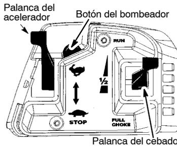
4. Firmemente, tire del cuerda de arranque hasta que el motor intente arrancar, pero no más de 5 veces (para temperaturas inferiores a -2°C, tire 8 veces).
