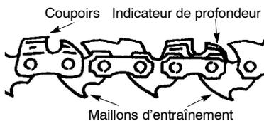
6. Passez la chaîne par dessus l'embrayage et derrière lui, adaptant les maillons d'entraînement dans le pignon de tambour de l'embrayage.
