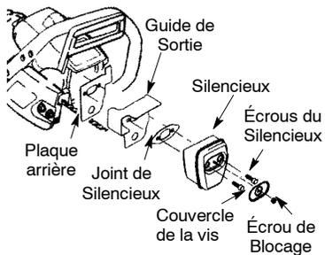
1. Desserrez et enlevez l'écrou de blocage du couvercle de la vis.
