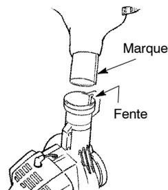
5. Introduisez le tube coudé dans la sortie de souffeuse. Assurez-vous que le marque du tube coudé est aligné avec la fente de la sortie de souffeuse.
