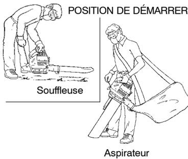
**AVERTISSEMENT:** Lors du démarrage, tenez l'appareil tel qu'indiqué. Lors du démarrage du moteur ou durant son fonctionnement, ne déposez l'appareil que sur une surface propre et solide. Des débris tels que gravier, sable, poussière, herbe, etc. pourraient s'introduire dans l'arrivée d'air, être projetés par la décharge et endommager l'appareil ou les biens ou causer de blessures graves à l'utilisateur ou à des tiers.
