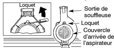
3. Soulevez doucement le bout du tournevis vers l'arrière de l'appareil à ouvrir la loquet en tirant sur le couvercle de l'arrivée de l'aspirateur avec l'autre main.
