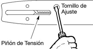
4. Haga deslizar la barra por detrás del cilindro del embrague hasta que la barra se detenga al tocar el engranaje del cilindro del embrague.
