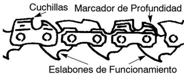
6. Coloque la cadena por encima y detrás del embrague, poner las eslabones de funcionamiento en el cilindro del embrague.
