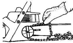
7. Coloque los eslabones de propulsión entre los dientes de la engranaje en la punta de la barra.
