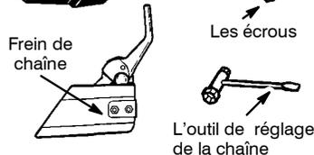
3. Tournez la vis de réglage sur la chaîne pour amener le mécanisme de réglage aussi loin que possible vers l'avant du guide-chaîne.
