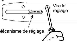
4. Glissez la barre derrière le cylindre de l'embrayage jusqu'à ce qu'elle bute contre le pignon du cylindre de l'embrayage.
