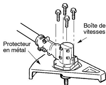
2. Insérez et vissez les 4 vis de montage à travers les trous de la boîte de vitesses et la protecteur en métal. Serrez-les fortement avec l'une clé hexagonale fournies.
