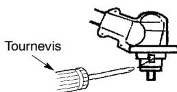
7. En maintenant le tournevis en position, montez la tête de coupe sur l'arbre dans la direction indiquée sur la décalcomanie (dans le sens inverse des aiguilles d'une montre). Serrez bien.
