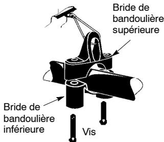
4. Insérez deux vis dans les trous de vis.
