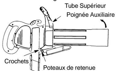
4. Pour fixer le tube inférieur au tube supérieur, alignez d'abord les flèches sur les deux tubes. Puis, poussez les deux tubes ensemble jusqu'à ce que le tube inférieur soit solidement rentré dans le tube supérieur (environ 3 pouces).
