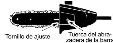
3. Gire el tornillo de ajuste a la derecha (en el sentido del reloj) hasta entra en contacto con sólidamente el fondo del riel de la barra guía. Luego, gire el tornillo de ajuste de la vuelta una 1/4 vuelta adicional.
