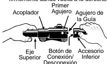
**⚠ ADVERTENCIA:** Antes de operar esta aparato, asegúrese de que el botón de conexión/desconexión esté asegurado en el primer agujero y la perilla esté bien ajustada. Todos los accesorios han sido diseñados para ser utilizados en el primer agujero. Para las accesorios opcional, vea la sección MONTAGE de la aplicables manual de instrucciones de la accesorio.
