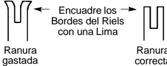
Cambie la barra si la ranura está gastada, si la barra está torcida o resquebrajada o si hay calentamiento excesivo o formación de protuberancias en los rieles. Si es necesario cambiar la barra, use exclusivamente la barra guía especificada para su cortadora de ramas en la lista de repuestos, especificada también en la calcomanía de repuesto de barra y cadena que se encuentra en la cortadora de ramas.
