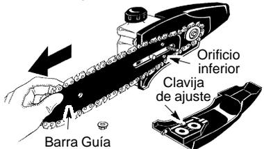
13. Instale las tuercas del abrazadera de la barra y ajústelas a mano únicamente. No los ajuste más por ahora. Vaya a la sección AJUSTE DE LA CADENA.
