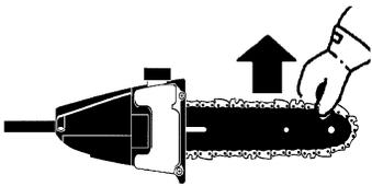
7. Use la punta en forma de destornillador de la herramienta de la barra para hacer rotar la cadena por la barra.
