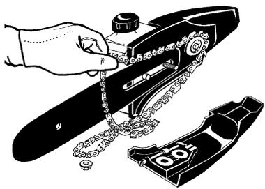
8. Coloque la cadena por encima y detrás del embrague, poner los eslabones de funcionamiento en el cilindro del embrague.
